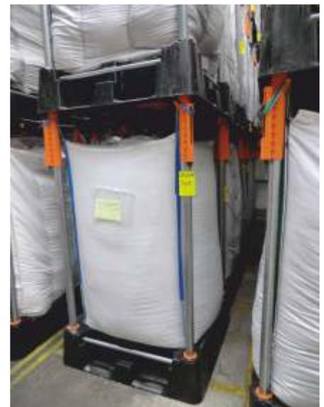
La stabilité et la rigidité furent améliorées par l'introduction d'une nouvelle nervure avec un système de renfort en métal.
